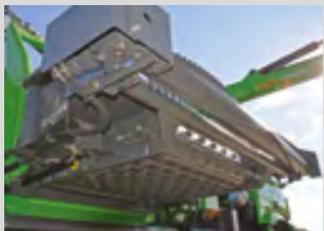
Rouleau hydraulique d'amenée à l'avant du tapis
