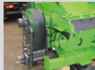
Transmission à courroies trapézoïdales
