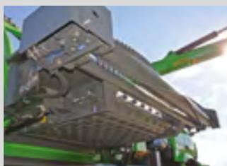
Rouleau hydraulique d'amenée à l'avant du tapis
