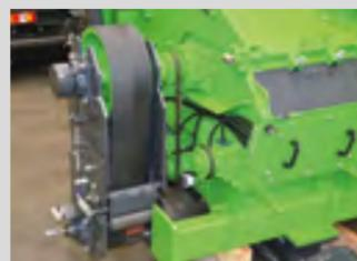
Transmission à courroies trapézoïdales
