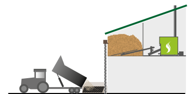
Silo en étage comme la chaudière, remplissage par souffleur ou convoyeur ascensionnel HEIZOTRANS.
