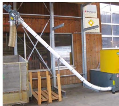
Plusieurs systèmes de convoyage à la sortie du broyeur sont possibles : aspiration, convoyeur ou aimants tubulaires
