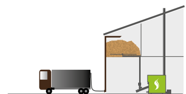
Silo en hauteur avec remplissage par camion souffleur
