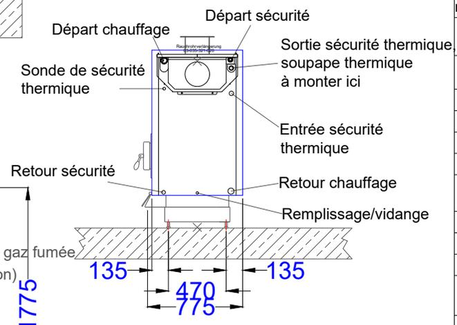
Il ne faut pas de socle béton sous la chaudière. La chaudière doit si possible être accessible sur trois faces. La vis d'alimentation ne doit si possible pas traverser la pièce. Sous réserve de modifications techniques destinées à l'amélioration du produit.
