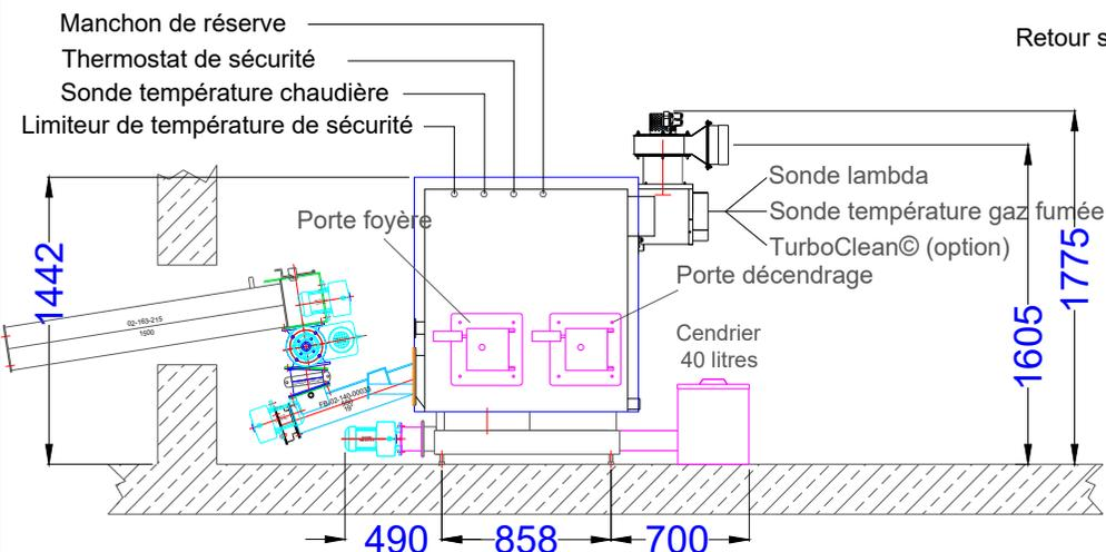
Il ne faut pas de socle béton sous la chaudière. La chaudière doit si possible être accessible sur trois faces. La vis d'alimentation ne doit si possible pas traverser la pièce. Sous réserve de modifications techniques destinées à l'amélioration du produit.
