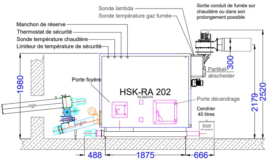
Il ne faut pas de socle béton sous la chaudière. La chaudière doit si possible être accessible sur trois faces. La vis d'alimentation ne doit si possible pas traverser la pièce. Sous réserve de modifications techniques destinées à l'amélioration du produit.
