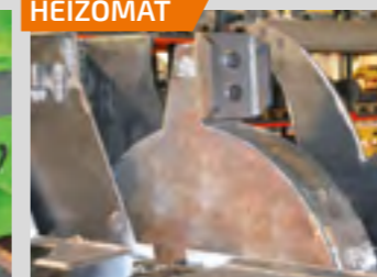
Soufflerie à volant d'inertie d'1 T = réserve de puissance ⊖conso, ⊖régul, ⊖solicitation moteur et rotor ⊕puissance/force, ⊕régularité
