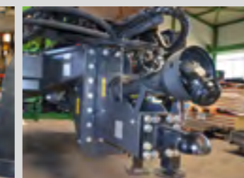
Hauteur d'attelage ajustable 500, 600, 900 ou 1000 mm
