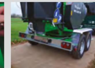
Châssis routier 80 km/h + barre de protection
