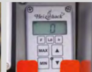
Système de commande no-stress Heizohack HE 002 pour réguler l'avancée du bois en fonction de la puissance d'entraînement.
