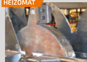
Soufflerie à volant d'inertie d'1 T = réserve de puissance ⊕conso, ⊕régul, ⊕solllicitation moteur et rotor ⊕puissance/force, ⊕régularité
