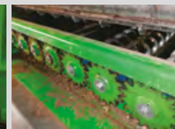
6 vis de nettoyage sous la table d'alimentation
