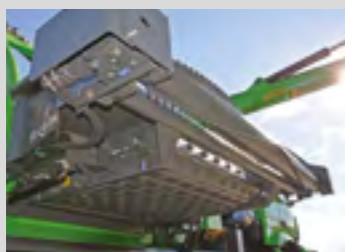
Rouleau hydraulique d'amenée à l'avant du tapis
