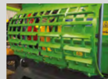
Grille avec déflecteurs : 45/60 mm, 60/80 mm, 80/80 mm Grille couvercle rotor : 45/60mm, 60/80mm
