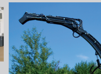
Goulotte télescopique électrique avec caméra (en option)
