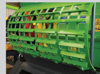
Grille avec déflecteurs : 45/60 mm, 60/75 mm, 75/80 mm
