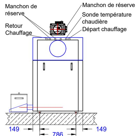
Il ne faut pas de socle béton sous la chaudière. La chaudière doit si possible être accessible sur trois faces. La vis d'alimentation ne doit si possible pas traverser la pièce. Sous réserve de modifications techniques destinées à l'amélioration du produit.
