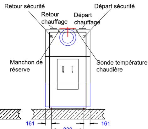
Il ne faut pas de socle béton sous la chaudière.
