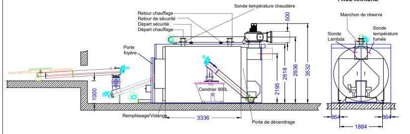
Il ne faut pas de socle béton sous la chaudière. La chaudière doit si possible être accessible sur trois faces. La vis d'alimentation ne doit si possible pas traverser la pièce.
