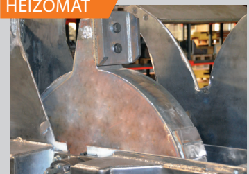
Soufflerie à volant d'inertie d'1 T = réserve de puissance ⊖ conso, -œgul, -œlllicitation moteur et rotor ⊕ puissance/force, + œgularité
