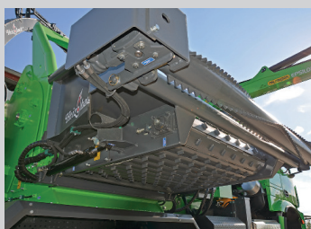
Rouleau hydraulique d'aménée à l'avant du tapis
