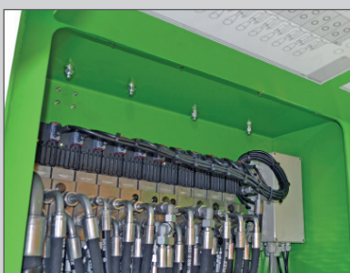
Bloc hydraulique avec levier pour fonctionnement manuel
