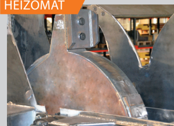
Soufflerie à volant d'inertie d'1 T = réserve de puissance ⊖ conso, - Ⓒégul, - Ⓞllicitation moteur et rotor ⊕ puissance/force, + Ⓒégularité
