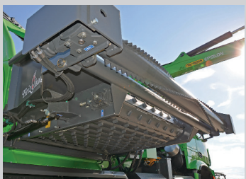
Rouleau hydraulique d'amenée à l'avant du tapis
