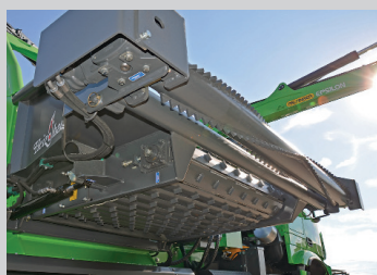
Rouleau hydraulique d'amenée à l'avant du tapis
