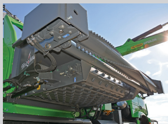
Rouleau hydraulique d'amenée à l'avant du tapis
