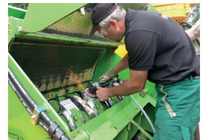
Rotor à couteaux à changement rapide et affûtage facile à poste.
