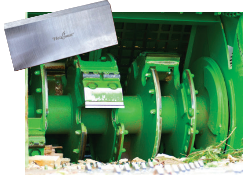
Rotor 6 couteaux 200 mm / 90 mm
