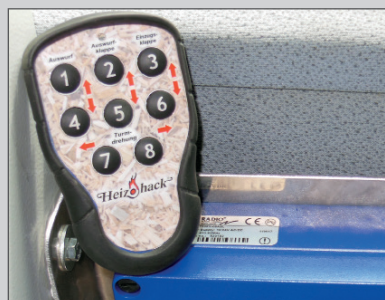
Télécommande radiocommandé pilotage de la goulotte d'éjection
