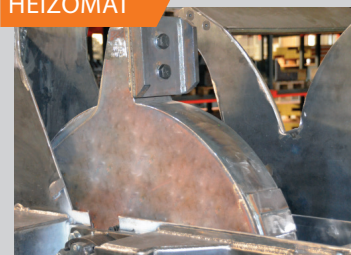
Soufflerie à volant d'inertie d'1 T = réserve de puissance ⊖ conso, - Régul, - Sollicitation moteur et rotor ⊕ puissance/force, + Régularité
