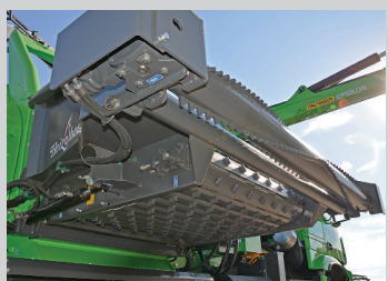
Rouleau hydraulique d'amenée à l'avant du tapis
