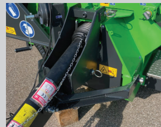
Adaptateur Hitch pour attelage bas (en option)
