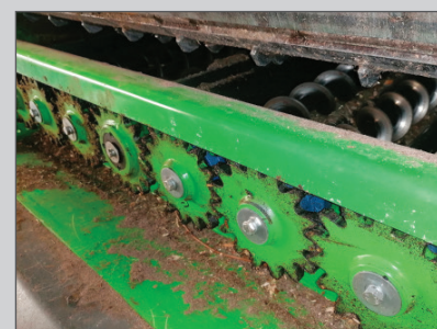
Vis de nettoyage sous la table d'alimentation (selon broyeur)
