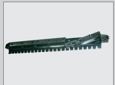
Contre-couteau modulaire renforcé par des pastilles de carbure de tungstène, retournable 1 fois : durée de vie x 8
