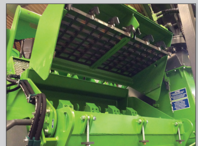
Double grille de calibrage : surface de calibrage x 3,5
