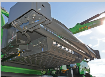
Rouleau hydraulique d'amenée à l'avant du tapis
