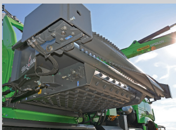
Rouleau hydraulique d'amenée à l'avant du tapis
