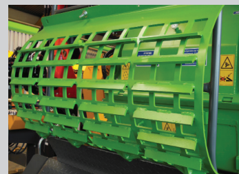
Grilles de calibrage changeables très facilement : 25/25 mm, 35/40 mm, 45/60 mm, 60/80 mm, 80/80 mm
