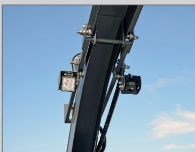
Caméra et éclairages LED placés sur la goulotte d'éjection pour une meilleure visibilité
