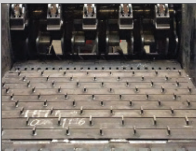
Tapis ameneur renforcé par des patins de glissement en Hardox : durée de vie x 4
