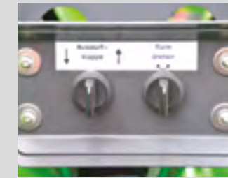
Goulotte orientable et casquette d'éjection réglable électriquement en option.
